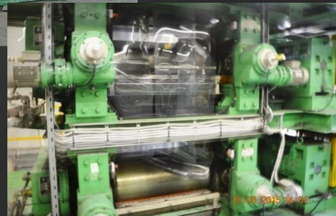
В производстве резиновых изделий вальцы **применяются**, для смешения, листования, подогрева и пластикации резиновых смесей, для дробления, размола, очистки старой резины и резиновых **отходов** в регенераторном **производстве**.
