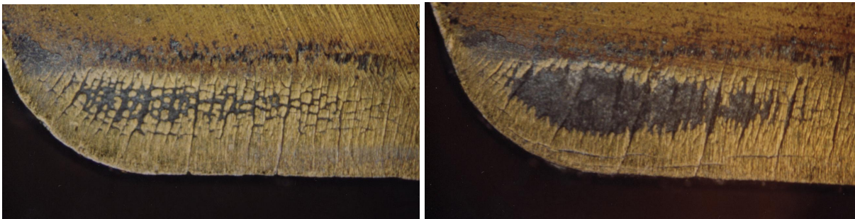
Рис. 65. Вид контактных площадок на передней поверхности твердосплавных пластин с покрытием TiN
