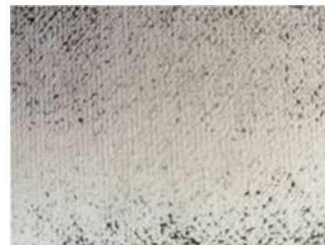
Оксид алюминия на медной подложке (Cu-base, Al 8,5...10,5 %, Fe ≤ 4%)
