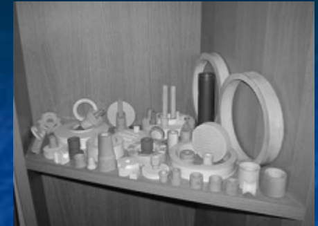
Рис. Образцы изделий из ZrO_2 - керамики
