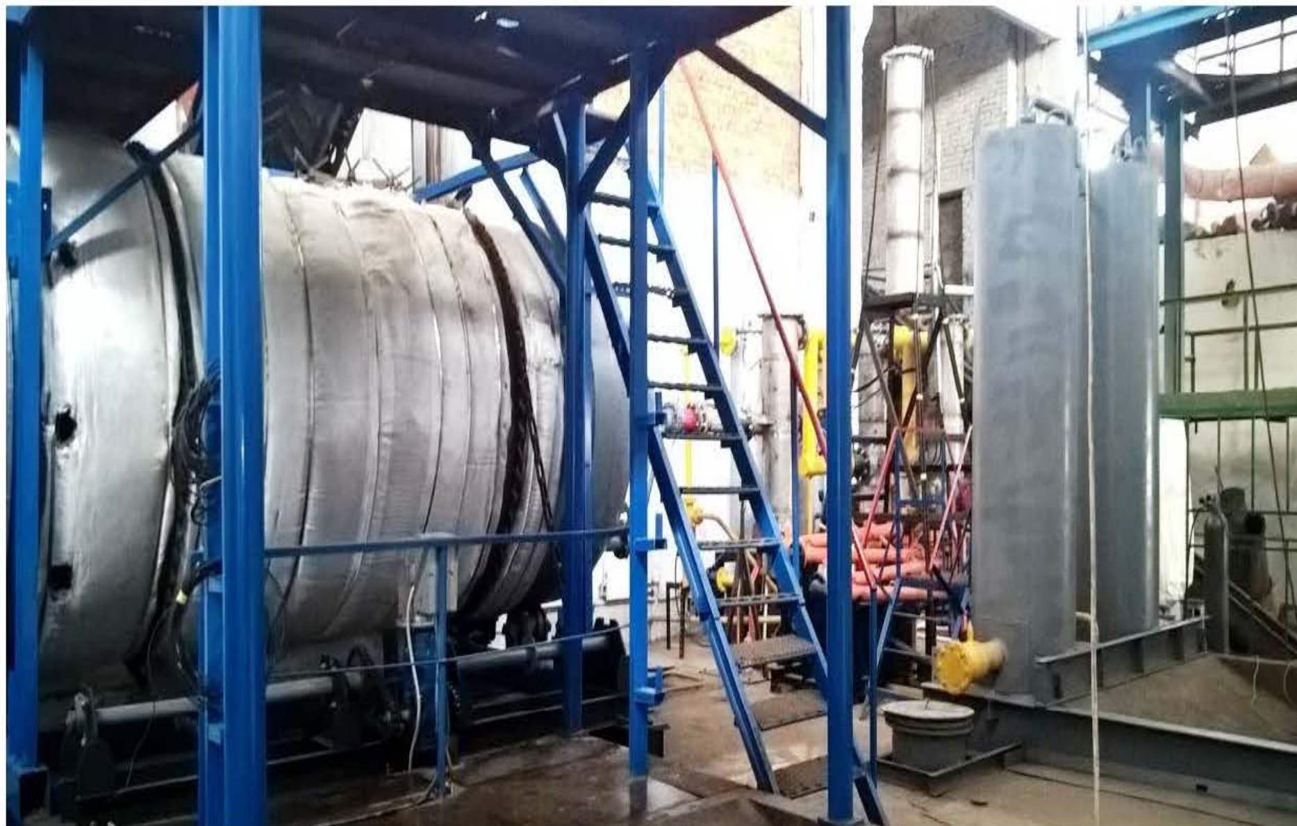
Пиролизный модуль «ЭКУОТ» конструкции ООО «ОЗОМ», готовый к доставке на опытно-демонстрационную площадку в г.Долгопрудный для участия в первом этапе инновационного проекта в составе комплекса термической переработки «хвостов» отходов.
